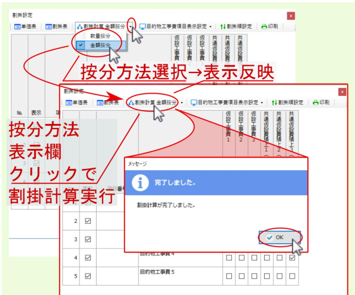
注釈：明細編集画面上部の経費計算をクリックして表示されるメニューより 割掛設定情報のクリア を選ぶと、設定していた割掛情報設定情報を初期化できます。
